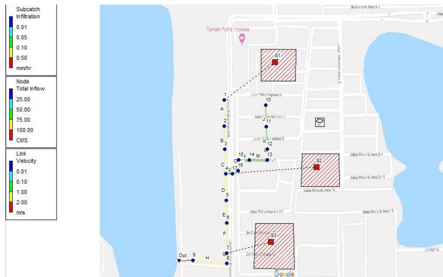
RAJAH 3. Hasil simulasi bagi kawasan tadahan, persimpangan dan perpaipan sistem pembetulan di kawasan kajian
