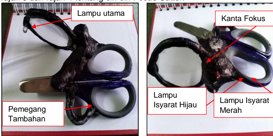
Gambar 3 dan 4. Alat intervensi Focus Cutter
