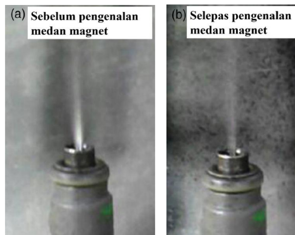
RAJAH 8. Perbezaan kesan semburan bahan api sebelum dan selepas rawatan magnet (Niaki et al. 2019)
