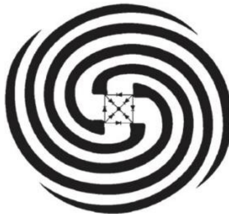
RAJAH 3. Spiralphase yang mempunyai rekabentuk lingkaran empat lengan atau elemen rod bersilang bersama diod (Bialkowski 2007)
