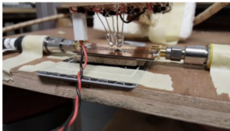
RAJAH 7. Contoh prototaip antenna tatasusun pantulan dengan menggunakan teknologi optik (Peter Alizadeh et al. 2016)
