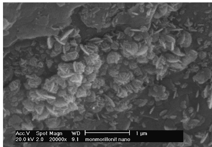
Rajah 4. Foto menunjukkan montmorillonit bersaiz nano selepas dikisar
