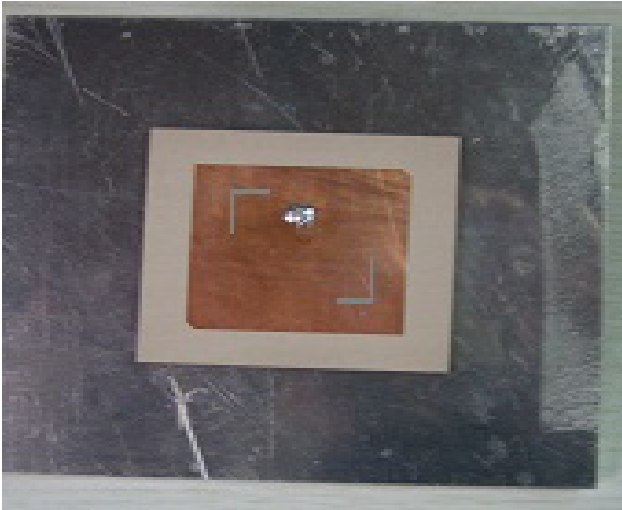
RAJAH 3. Prototaip antenna yang dibangunkan
