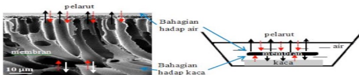
Rajah 3 Ilustrasi penghasilan liang semasa penyongsangan fasa Sumber:Loo, Kooi Keat 2016
