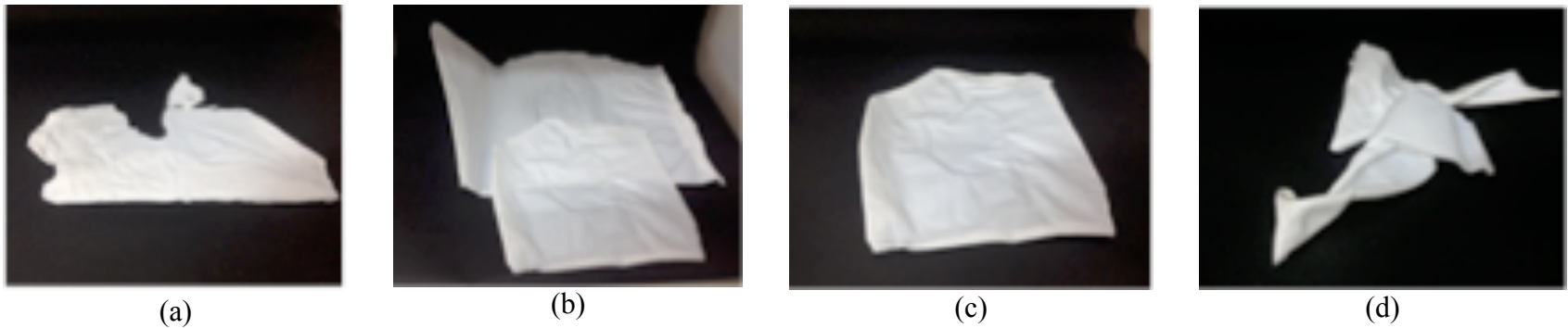
Rajah 1 Pembentukan membran PAN selepas pengeringan dengan pelarut DMF yang berkomposisi a) 5:95 wt/wt %, b) 8:92 wt/wt %, c) 10:90 wt/wt % dan d) 12:82 wt/wt %
